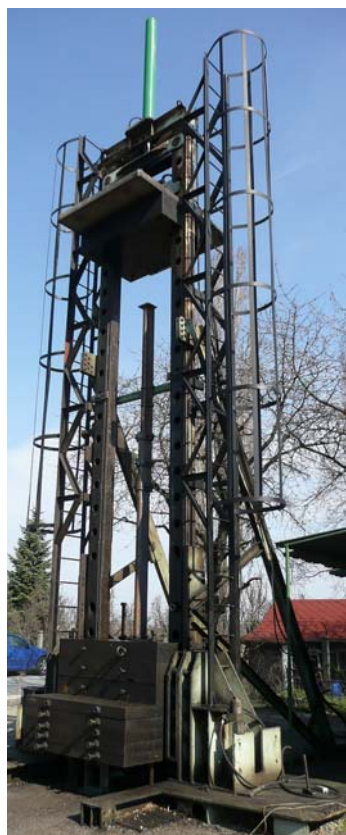
Obr. 1 - Mechanická vzpěra umístěná v padostroji před dynamickou zkouškou Základní technické údaje:
