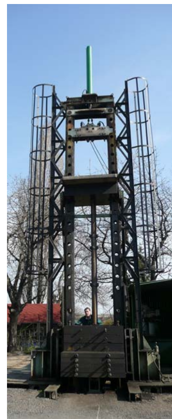
Obr. 2 - Mechanická vzpěra umístěná v padostroji po dynamické zkoušce
