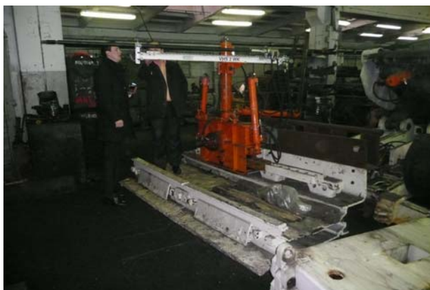
Vrtačka VHS 2 WK KWK Jas Mos – Hydraulický upínací přípravek na tělese dopravníku
