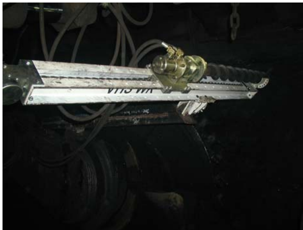
Vrtačka VHS 1 WK Důl ČSA – na rameni kombajnu
