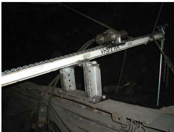
Vrtačka VHS 2 WK Důl Paskov – Na bočním plechu v nízkým rubání
