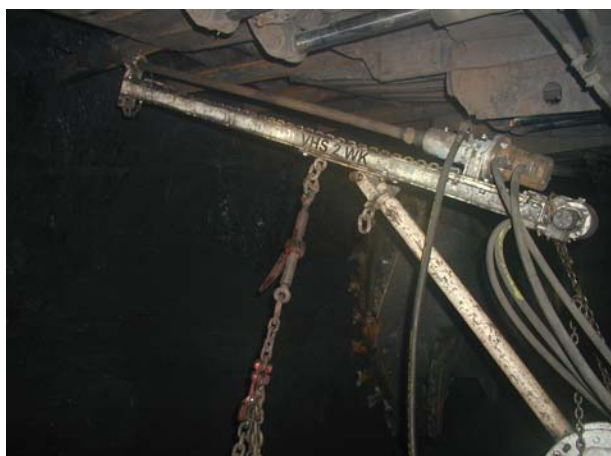
Vrtačka VHS 2 WK Důl ČSM Sever – úchyt na bočním plechu dopravníku
