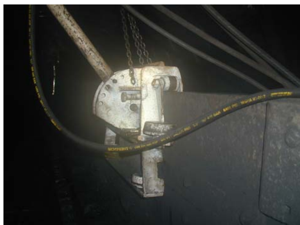
Vrtačka VHS 2 WK Důl ČSM Sever – úchyt na bočním plechu dopravníku
