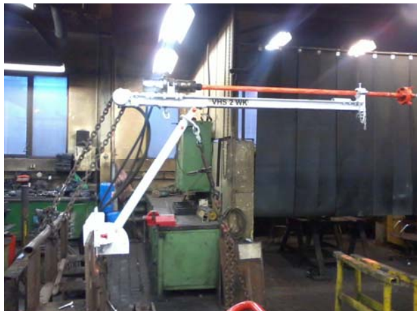
Vrtačka VHS 2 WK Důl ČSM Jih – úchyt na bočním plechu dopravníku
