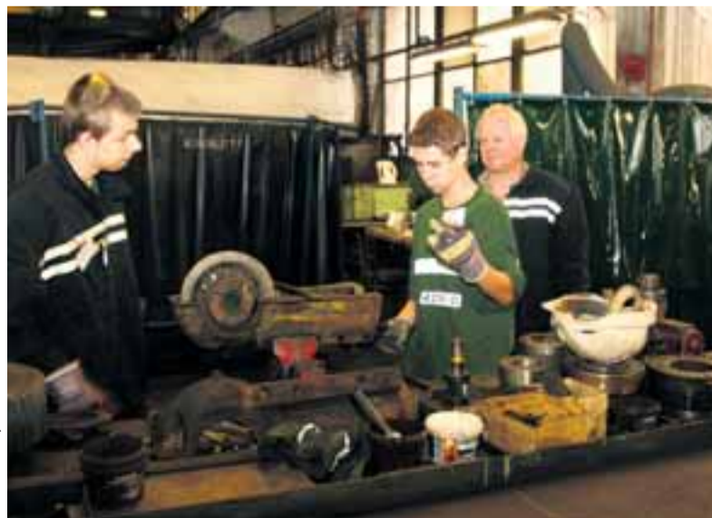
Budoucí důlní zámečnick opravují převodovku dopravníku k razičím kombajnu AM 50. Jejich práci bedlivě sleduje zámečnick VOJ SC Ladislav Szweda.
