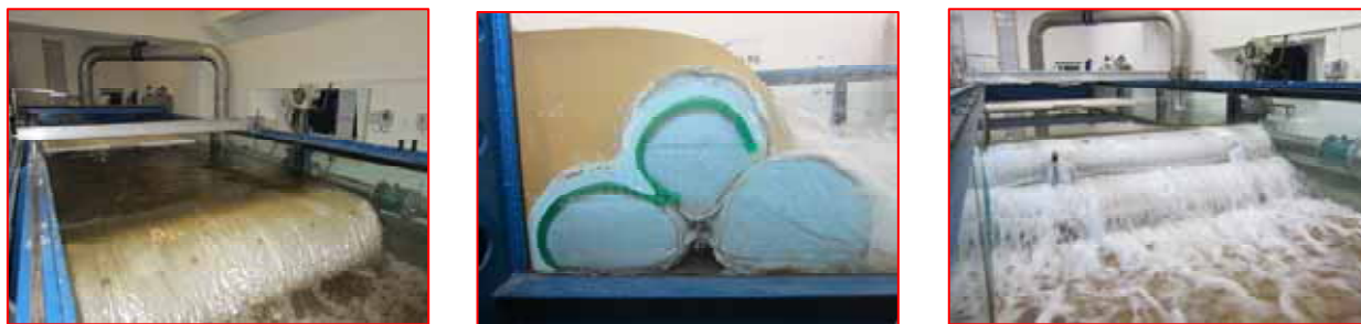
Obr. 4 – 6 Hydraulické zkoušky v Laboratoři vodohospodářského výzkumu (LVV) na VUT v Brně
